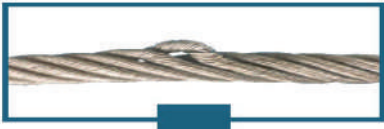
Damar bükülmesi yada dışarı çıkması
