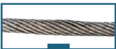
Öz hasarlanmasından kaynaklı çap artışı
